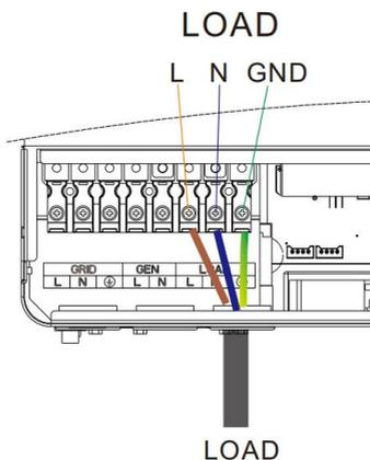
**注意：**接地线缆尽量用粗线径（导线截面积不小于 $4\text{mm}^2$ ），接地点尽量靠近一体机，接地线越短越好。
