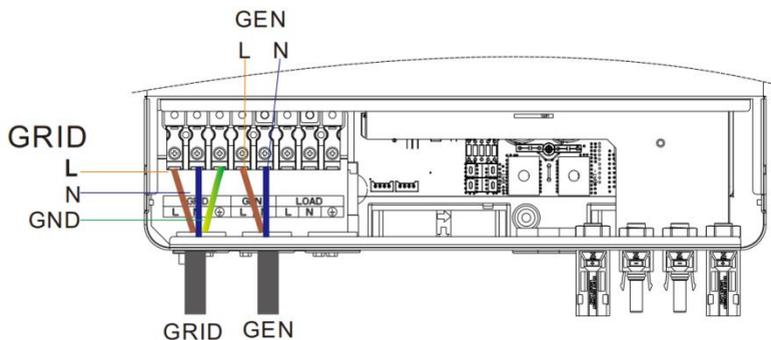
根据下图所示线缆顺序和端子位置，正确接上交流输出线，请先接地线，再接火线和零线，地线通过 O 型端子接到机箱接地螺丝孔。
