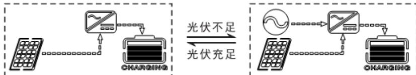
4) **仅光伏充电(Only Solar):**仅光伏充电，不启动市电充电。这种方式为最节能方式，电池电能均来自于太阳能，通常在光照条件好的地区使用。
