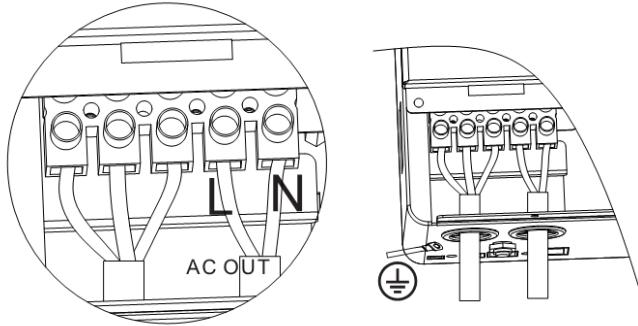
注意：接地线缆尽量用粗线径（导线截面积不小于 4mm<sup>2</sup>），接地点尽量靠近一体机，接地线越短越好。
