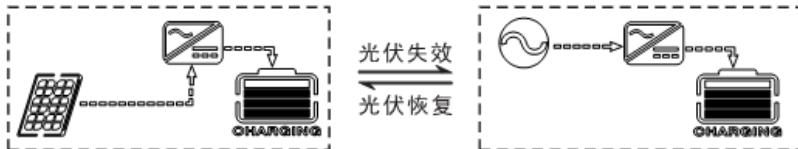
2) **市电优先:**市电优先给蓄电池充电，只有在市电无效的时候才启动光伏充电。
