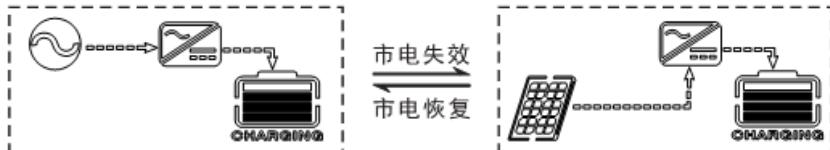
3) **混合充电:**光伏和市电混合充电，优先光伏MPPT充电，光伏能量不足时，市电补充。光伏能量充足时，市电停止充电。这种方式充电最快，适合电网不稳定地区，随时可以提供充足的后备电源供应。
