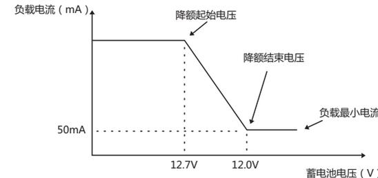
否(关闭)-关闭智能功率,负载功率根据设定时间段的功率输出。
