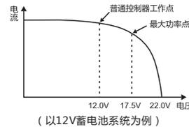
MPPT的全称“最大功率点跟踪”(Maximum Power Point Tracking),是一种先进的充电方式。MPPT控制器能够实时侦测太阳能板的发电功率,并追踪最高电压电流值(VI),使系统以最高的效率对蓄电池充电。相比传统的PWM控制器,MPPT控制器能够发挥电池板的最大功率,所以能够提供更大的充电电流,一般来说MPPT比PWM控制器能提高15%~20%的能量利用率。
