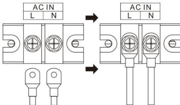
③根据下图所示线缆顺序和端子位置，正确接上交流输出线火线和零线，地线通过 O 型端子接到机箱接地螺丝孔。
